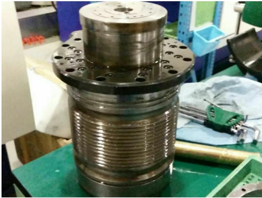
数控加工中心电主轴的机械维修1. 高速电主轴负载。维修故障缘故: 钻削过多、经常的正反转、主轴轴承电机常见故障、主轴轴承驱动器设备常见故障。2. 高速电主轴不转: 维修故障缘故: 主轴轴承驱动器设备常见故障、数控机床设备没法输出转速比数据信号、主轴轴承电机常见故障、主轴轴承驱动器设备常见故障、皮带破裂。3. 高速电主轴转速比偏移命令值: 维修故障缘故: 电机负载、数控机床输出的主轴轴承转速比命令输出不太好、限速设备有常见故障或是速率意见反馈数据信号断开。4. 高速电主轴出现异常噪音及震动: 维修故障缘故: 一般在降速全过程中产生, 主轴轴承驱动器设备不太好, 如沟通交流驱动器中的再造控制回路常见故障。常州萨克电主轴维修哪家好电主轴维修的组件设备时有必要坚持同心度和笔直度都非常重要。
