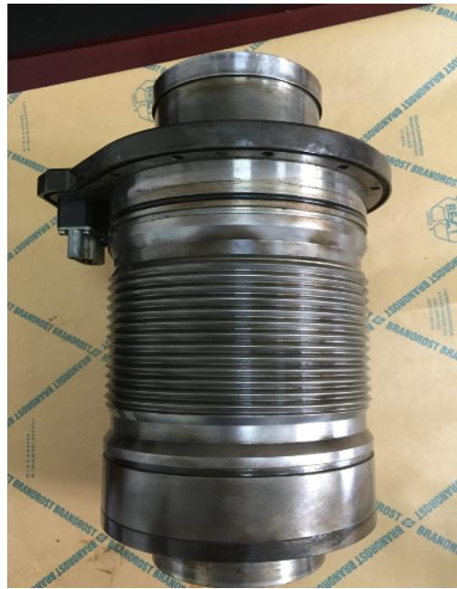
电主轴故障现象及维修方法工作时噪声过大：（1）主轴部件动平衡不良，使主轴回转时振动过大，引起工作噪声。需要机床生产厂家的专业人员对所有主轴部件重新进行动平衡检查与调试。（2）主轴传动齿轮磨损，使齿轮啮合间隙过大，主轴回转时冲击振动过大，引起工作噪声。需要机床生产厂家的专业人员对主轴传动齿轮进行检查、维修或更换。（3）主轴支承轴承拉毛或损坏，使主轴回转间隙过大，回转时冲击、振动过大，引起工作噪声。需要机床生产厂家的专业人员对轴承进行检查、维修或更换。（4）主轴传动带松弛或磨损，使主轴回转时摩擦过大，引起工作噪声。通过调整或更换传动带加以排除。
